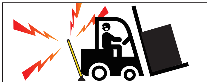
《衝突警報システム》 車両が衝突すると、警報を発し、運転者に危険を知らせます
